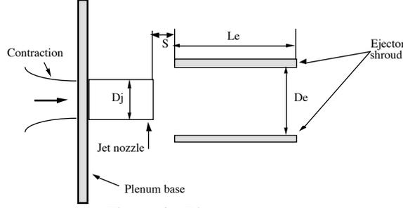
Figure 4 - Ejector parameters
